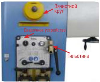
Устройство для сварки и зачистки пил
